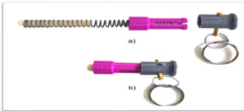
Fig. 6 Mecanismul de Declanșare a) Nearmat; b) Armat, cu siguranță;
