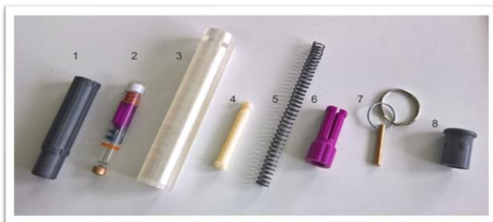
Fig. 5 Componentele prototipului: 1 – cartuș; 2 - carpulă 3 – carcasă; 4 - piston; 5 – arc; 6 – declanșator; 7 – cui de siguranță; 8 – capac
