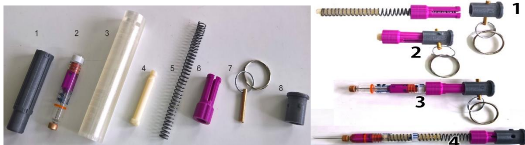
Fig. 1 Componentele prototipului realizat până în prezent: 1 – cartuș; 2 – carpulă cu piese de ghidare; 3 – carcasă; 4 - piston; 5 – arc; 6 – declanșator; 7 – cui de siguranță; 8 – capac
