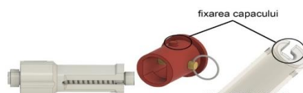
Fig. 3 Construcția sistemului de injecție
